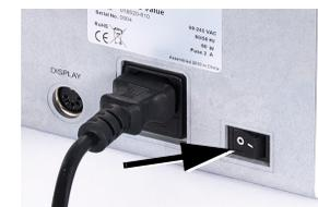
La macchina si avvia e carica tutti i parametri di inizializzazione. La macchina viene automaticamente impostata in modalità conteggio batch. Il display visualizza la cifra «0» per conteggio e «100» per batch.
