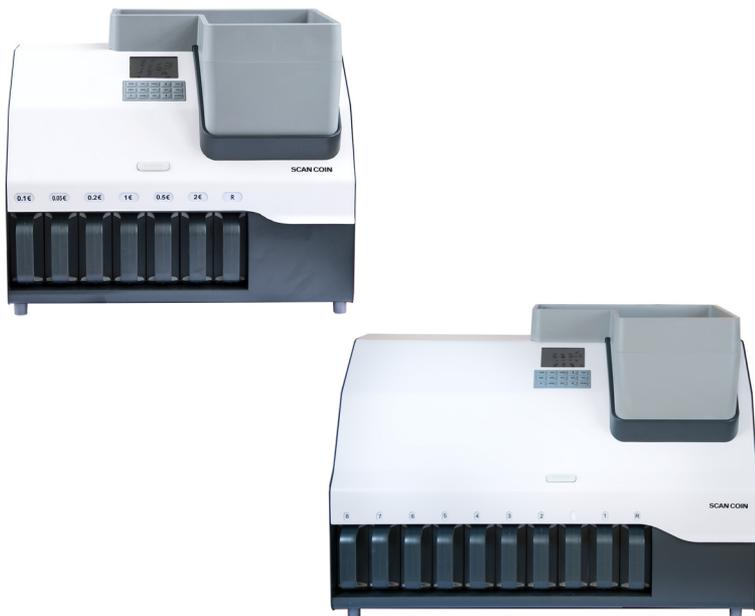
**DTC9** - L'unità più grande del gruppo, presenta nove posizioni di selezione e una posizione di scarto. Tutte le posizioni presentano etichette intercambiabili. DTC9 può selezionare fino a 9 tagli. DTC9 Active è dotata di un'elettrovalvola supplementare per contare e separare un taglio di diametro molto simile o per separare una valuta.
